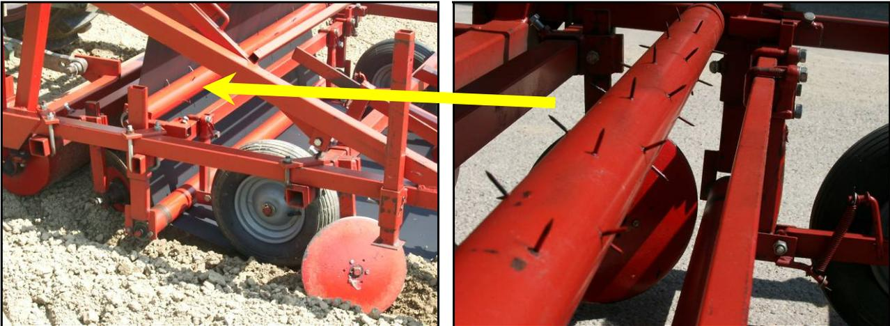
Stachelwalze zur Perforation an einem Verlegegerät
