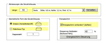
Wichtige Größen für die Kalkulation sind in einer Access-Datenbank gespeichert. Zum Beispiel Eigenschaften unterschiedlicher Eindeckungsmaterialien oder der Preis von Heizöl, diese können einfach ausgewählt werden und bei Bedarf auch geändert oder ergänzt werden.
